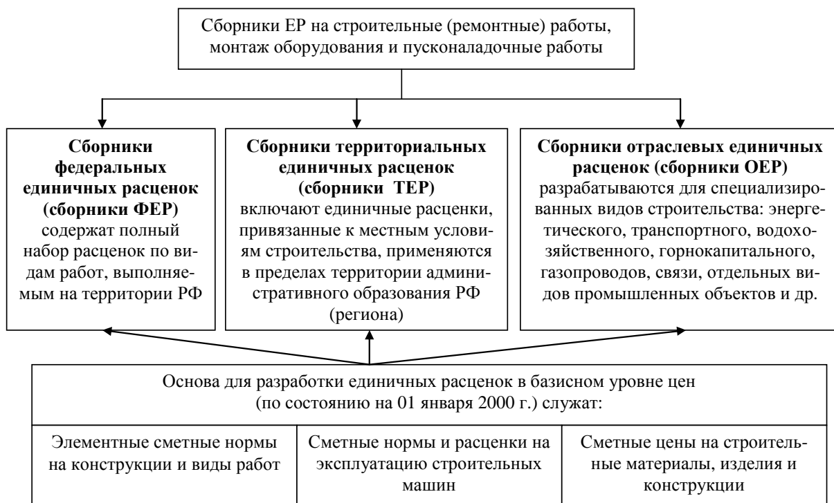
Рис. 2. Классификация сборников единичных расценок на строительные (ремонтные) работы, монтаж оборудования и пусконаладочные работы и методическая основа для их формирования
